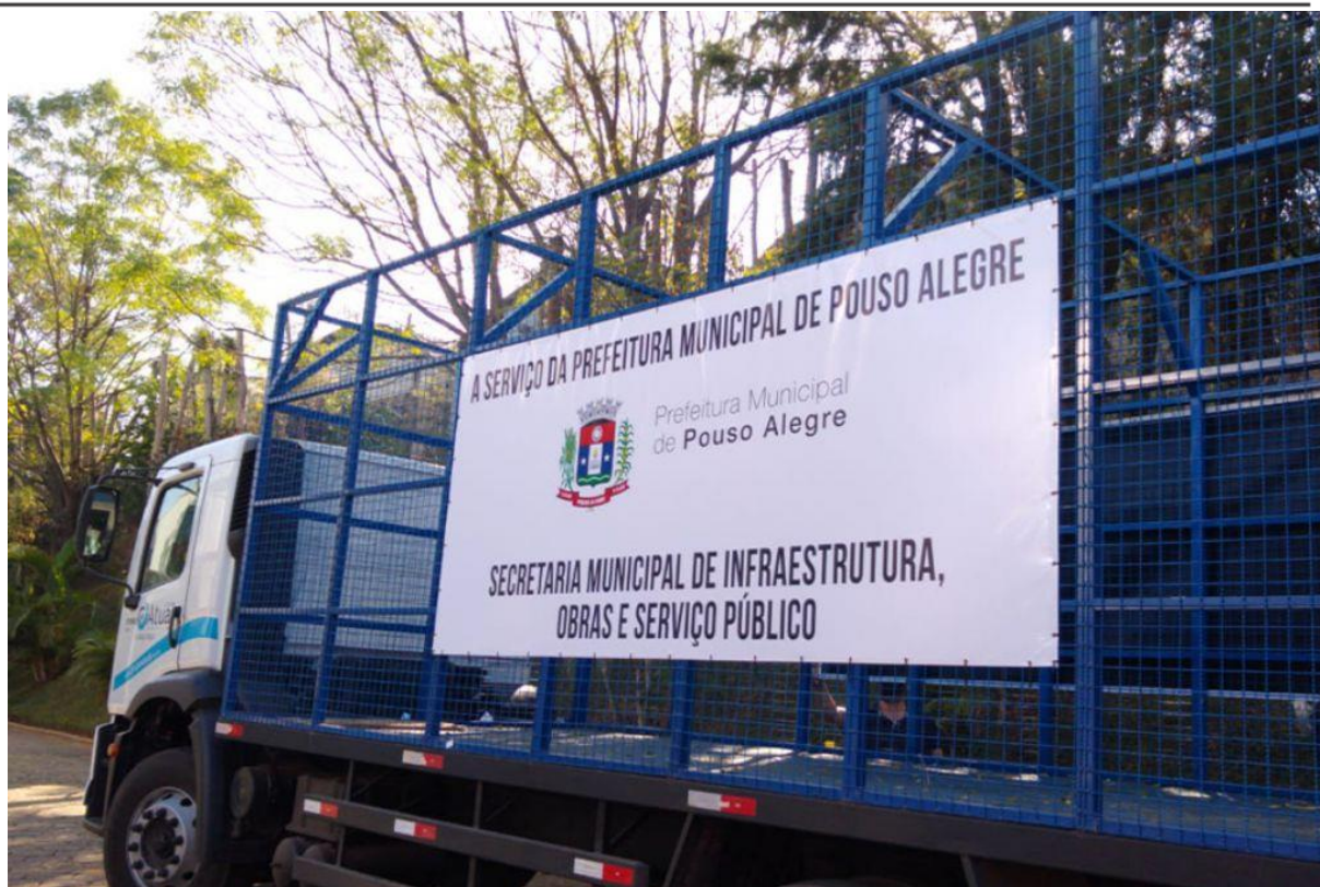
Figura 45 - Caminhão gaiola para serviço de coleta seletiva da limpeza urbana do município
