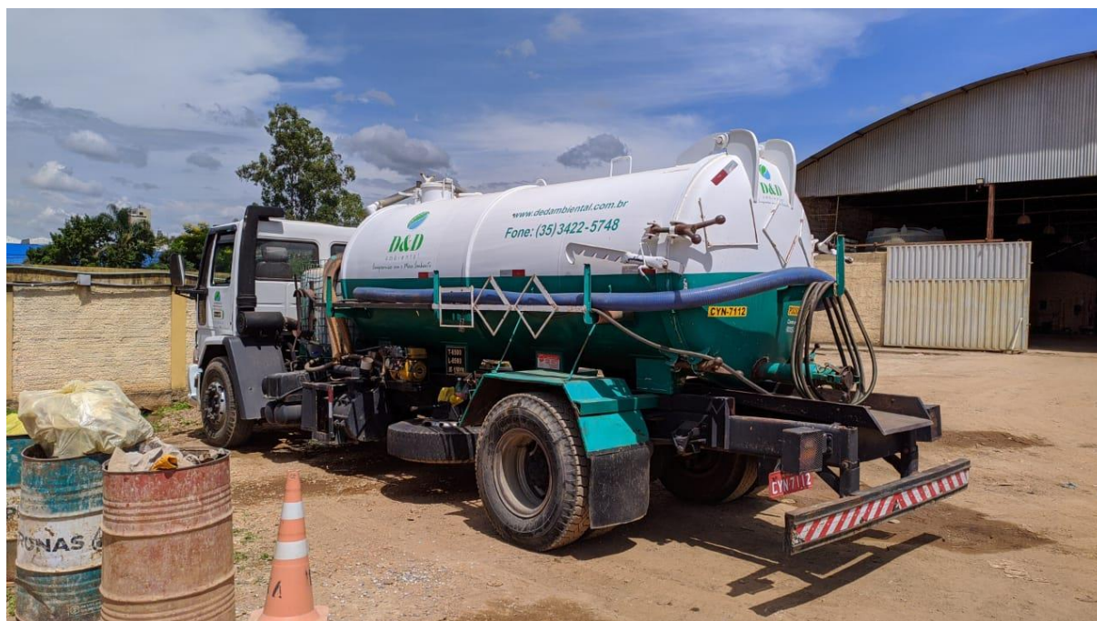
Figura 43 - Caminhão de limpeza de boca de lobo
